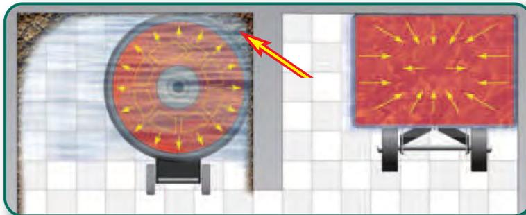
**Прямоугольник или Круг:** В отличие от традиционных роторных машин, использующих круглые пады, EDGE-узел имеет прямоугольную форму. Благодаря этому достигается равномерное воздействие всей площади пада на обрабатываемую поверхность. Кроме того, прямоугольная форма позволяет обрабатывать пол в углах помещения и возле стен.
