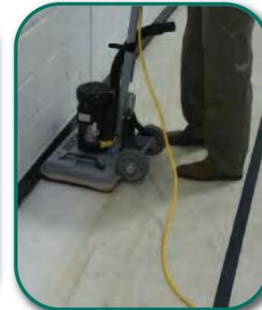
Универсальные машины для обработки пола **EDGE** способны удалять необходимое количество слоёв защитных покрытий без использования специальных химических средств. Благодаря этому, обеспечивается значительное снижение расходов и высокая безопасность окружающей среды и персонала.
