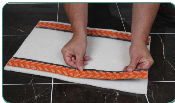
Рисунок 3-А: Закрепите алмазные пластины на расстоянии 1,2 - 1,3 см от края пада. В этом случае они будут находиться точно по краю рабочей платформы. Если необходимо обработать пол непосредственно возле стены, одну пару пластин расположите на краю, а вторую - на расстоянии 2,5 см от другого края.
