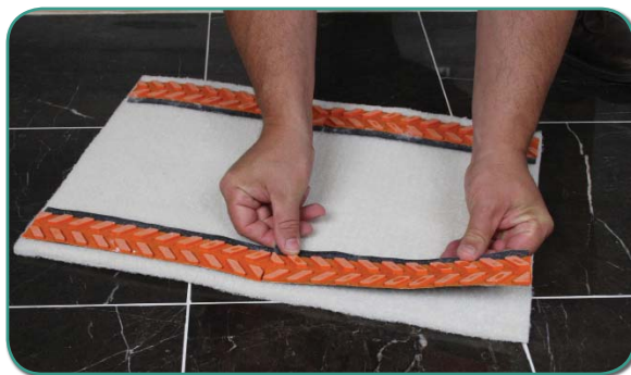
Рисунок 1-А: Закрепите алмазные пластины на расстоянии 1,2 - 1,3 см от края пада. В этом случае они будут находиться точно по краю рабочей платформы. Если необходимо обработать пол непосредственно возле стены, одну пару пластин расположите на краю, а вторую - на расстоянии 2,5 см от другого края.
